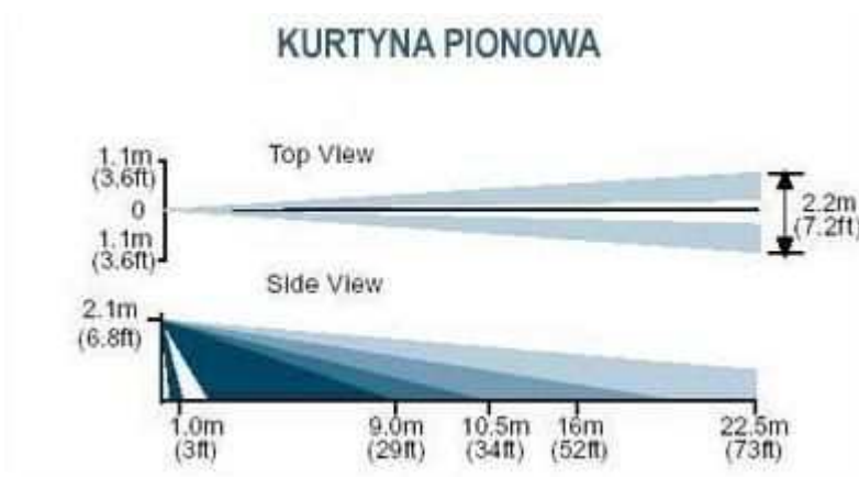
Rys. 3. Soczewka kurtynowa (pionowa)
